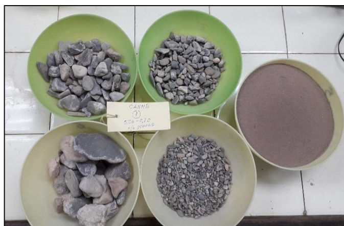
Fig.7. Separación de piedras y gravas gruesas (>25,4mm); gravas intermedias (>12,7mm); gravas finas (>6,3 mm); gravillas (> 2mm) y tierra fina seca al aire (< 2 mm).
