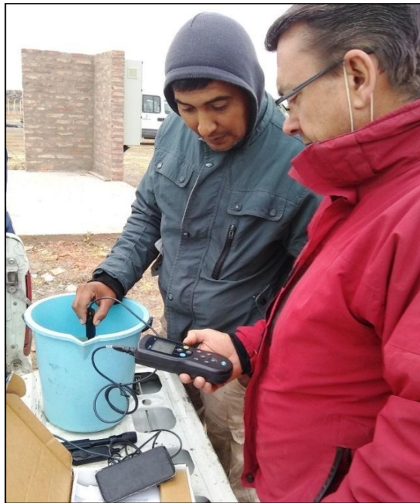
Fig.5. Medición in situ de parámetros químicos del agua de perforación.
