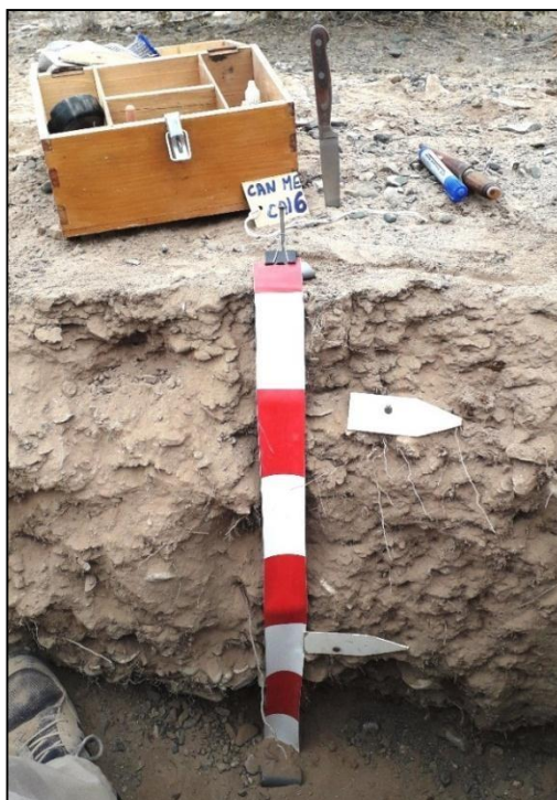
Fig.3. Descripción del perfil de suelo en Calicata 6.
